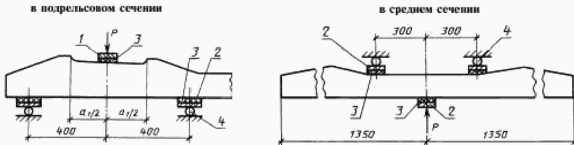
1 — стальная пластина с уклоном нижнего основания 1:20 размером  $250 \times 100$  мм, средней толщиной 25 мм; 2 — стальная пластина размером  $250 \times 100 \times 25$  мм; 3 — резиновая прокладка размером  $250 \times 100 \times 10$  мм; 4 — стальной валик диаметром 40 и длиной 250 мм
